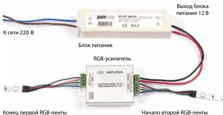
СХЕМА 6. Подключение усилителя мощности
