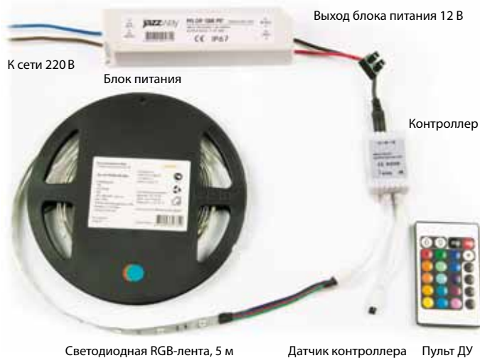
СХЕМА 5. Подключение многоцветной (RGB) светодиодной ленты
