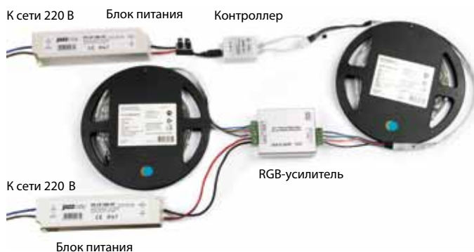
СХЕМА 7. Подключение двух RGB-лент с помощью усилителя мощности
