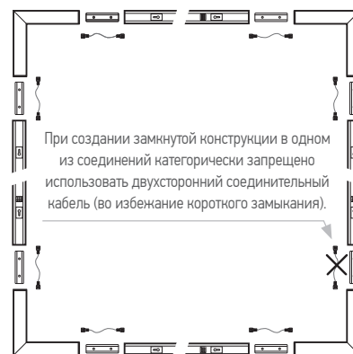
Схема соединения светильников PSO-02 с помощью светильника PSO-02 L
