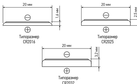
ЛИТИЕВЫЕ дисковые элементы питания являются источником энергии для большинства современных компактных электронных устройств (пульты дистанционного управления, бесконтактные ключи, калькуляторы и т.д.).
