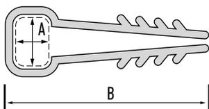
Предназначены для крепления плоских кабелей и проводов на несущих строительных конструкциях. Быстрое и надежное крепление без использования дюбелей и шурупов.
