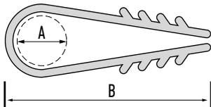
Предназначены для крепления круглых кабелей и проводов на несущих строительных конструкциях. Быстрое и надежное крепление без использования дюбелей и шурупов.
