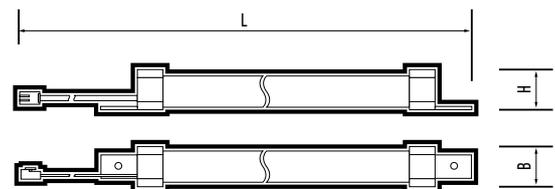
PEPP40-1.0H IP20. (Габаритные размеры аккумулятора)
