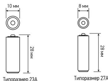
СПЕЦИАЛЬНЫЕ щелочные батарейки предназначены для использования в пультах автомобильных сигнализаций, дверных беспроводных звонков и других компактных устройствах.
