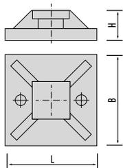
Предназначены для крепления кабельных стяжек к плоским поверхностям внутри зданий и сооружений. Самонклеющийся слой на оборотной стороне. Стойкость к ультрафиолету, солям, щелочам, кислотам, бензину, спирту и маслам.
