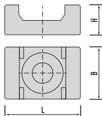
Предназначены для крепления кабельных стяжек к плоским поверхностям внутри зданий и сооружений. Стойкость к ультрафиолету, солям, щелочам, кислотам, бензину, спирту и маслам.
