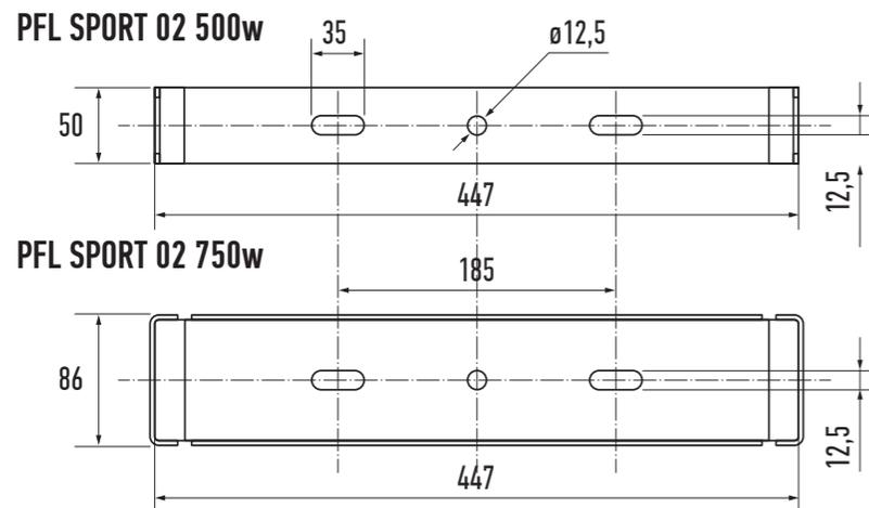
Рис. 3 Установочные размеры скобы крепления.
