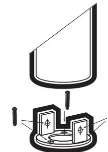
Рис.6 Схема крепления светильника PGB 04-800 к опорной поверхности
