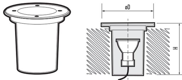
Рис.1 Габаритные размеры и разрез светильника PGR R110
