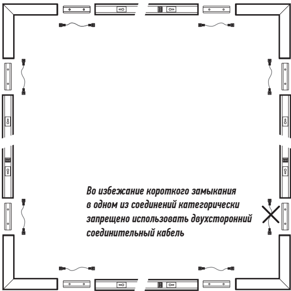
Рис. 3 Схема соединения замкнутой конструкции светильников PSO-02 с помощью светильника PSO-02 L 16W 4000K BLACK IP40
